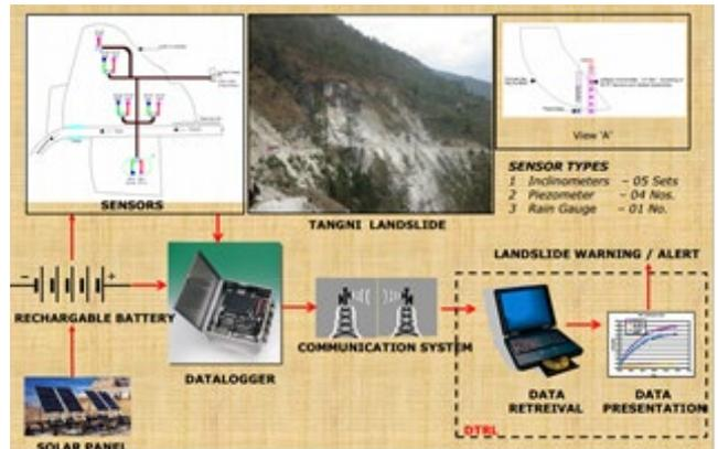
圖 20 Tangni 山崩監測流程
