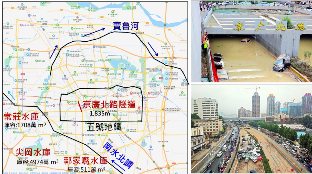
圖 8 鄭州市京廣北路隧道淹水情形。圖資來源[31, 32]
