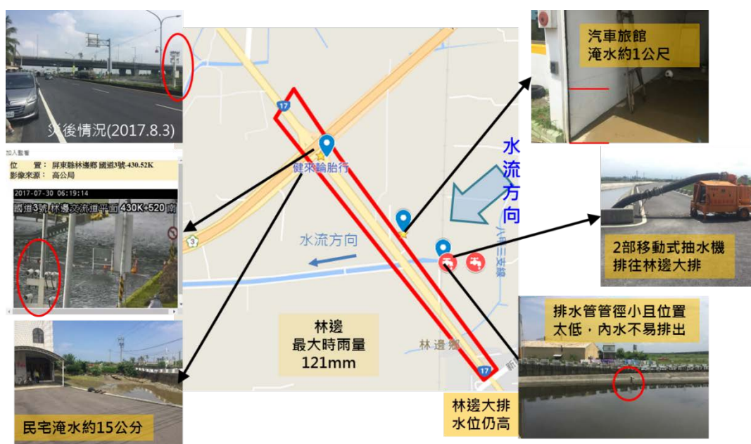
圖 2.4 屏東縣林邊交流道與台 17 線淹水災情分析 (紅框為水利署調查之淹水範圍，照片來源：本中心)
