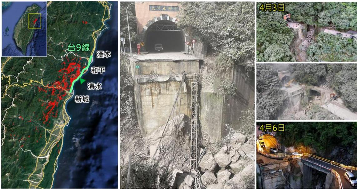
圖 5-13、清水溪位置、橋體受損與工程修復狀況。左側地圖之紅色區域為農業部農村發展及水土保持署之 0403 花蓮地震崩塌判釋成果。(資料來源：公民回報、鄭宏達等，2024)
