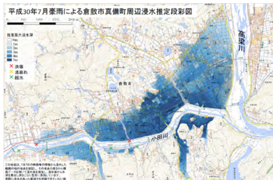
高梁川流域 (含小田川) 淹水分布圖，紅色 X 顯示為本次小田川堤防潰堤處 (資料來源：國土交通省國土地理院)
