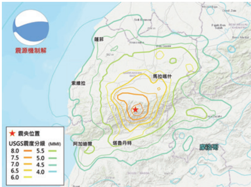
本次地震震央位置及地表震度分布 (資料來源：美國地質調查所)
