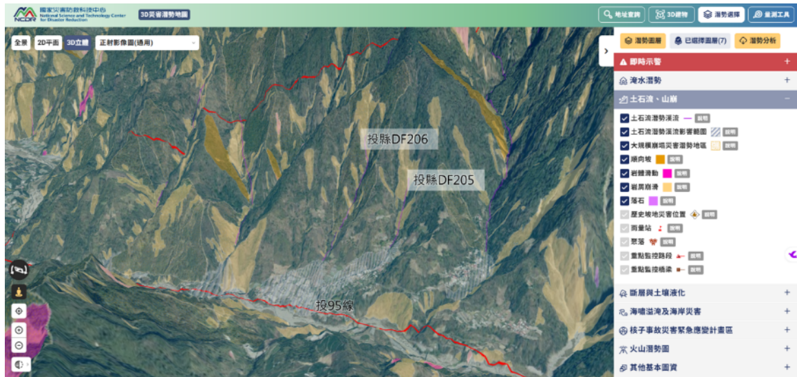
圖 3.2.24、東埔村土石流與崩塌災害潛勢地圖(資料來源：農村水保署；製圖：災防科技中心)
