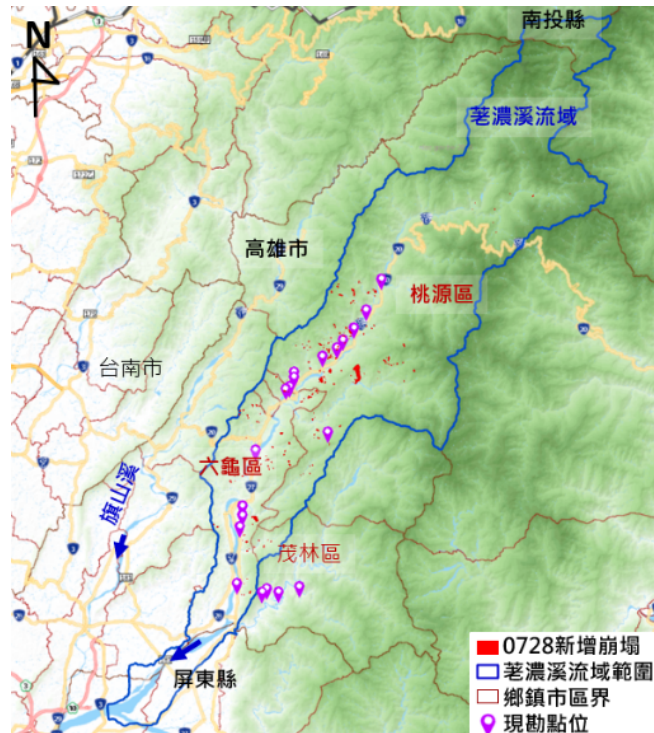
圖 3.2.8、老濃河流域 0728 豪雨之新生崩塌分布情形與勘災點位
