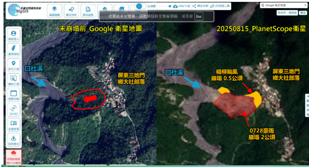
圖 3.2.19、大社部落崩塌發展圖(資料來源：農村水保署)
