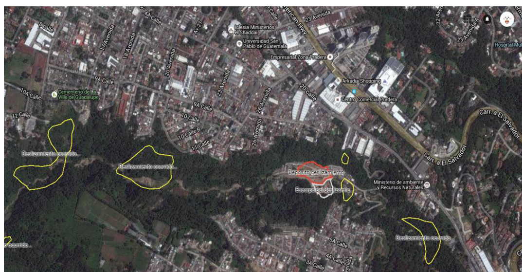
圖 104. 白色與紅色線框分別表示此次崩塌與堆積範圍，黃色線框代表 1976 年瓜地馬拉所發生芮氏規模 7.5 大地震造成之崩塌範圍 (Rüdiger Escobar Wolf of Michigan Technological University; Harp et al., 1981)
