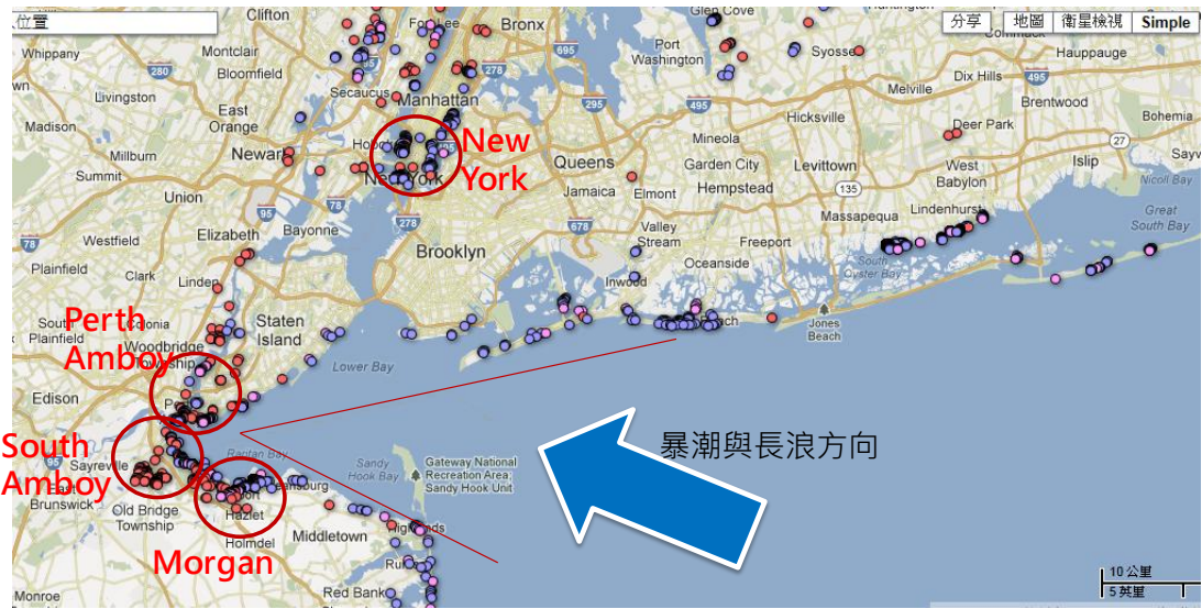
圖 10 峽灣地形使紐約市遭受暴潮衝擊下災害更為嚴重(圖中圓點為 FEMA 災後調查建物位置及災情，藍色：只有淹水、紫色：淹水及結構受損、紅色：只有結構受損)
