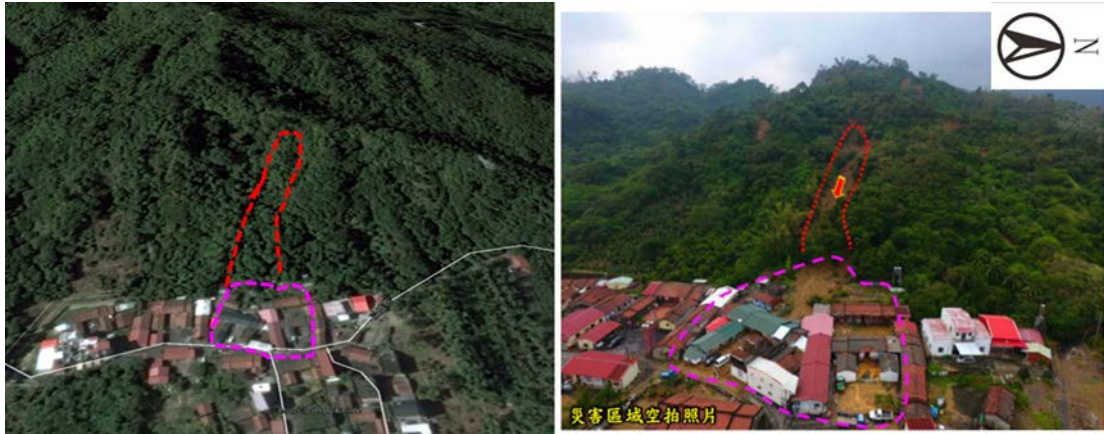
圖 15 旗山區後厝巷崩塌前後照片比對（圖片來源：左為 Google 於 2012 年拍攝影像，右為水土保持局災後拍攝影像）
