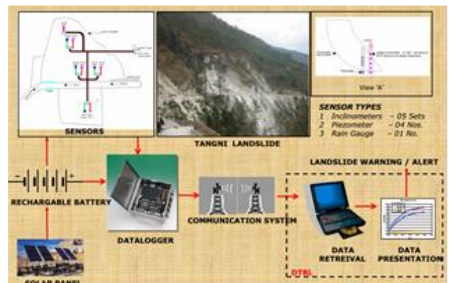
圖 20 Tangni 山崩監測流程
