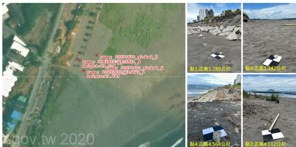
圖 2.11、大坑觀景台外側設置地面控制點，量測最新正高狀況(資料來源：災防科技中心)
