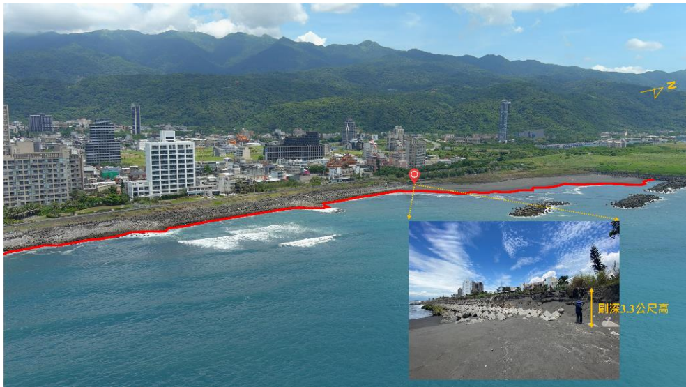
圖 2.10、災防科技中心前往大坑海岸進行側拍紀錄，紅色線表示岸線現況位置，標點為最大刷深位置(資料來源：災防科技中心)
