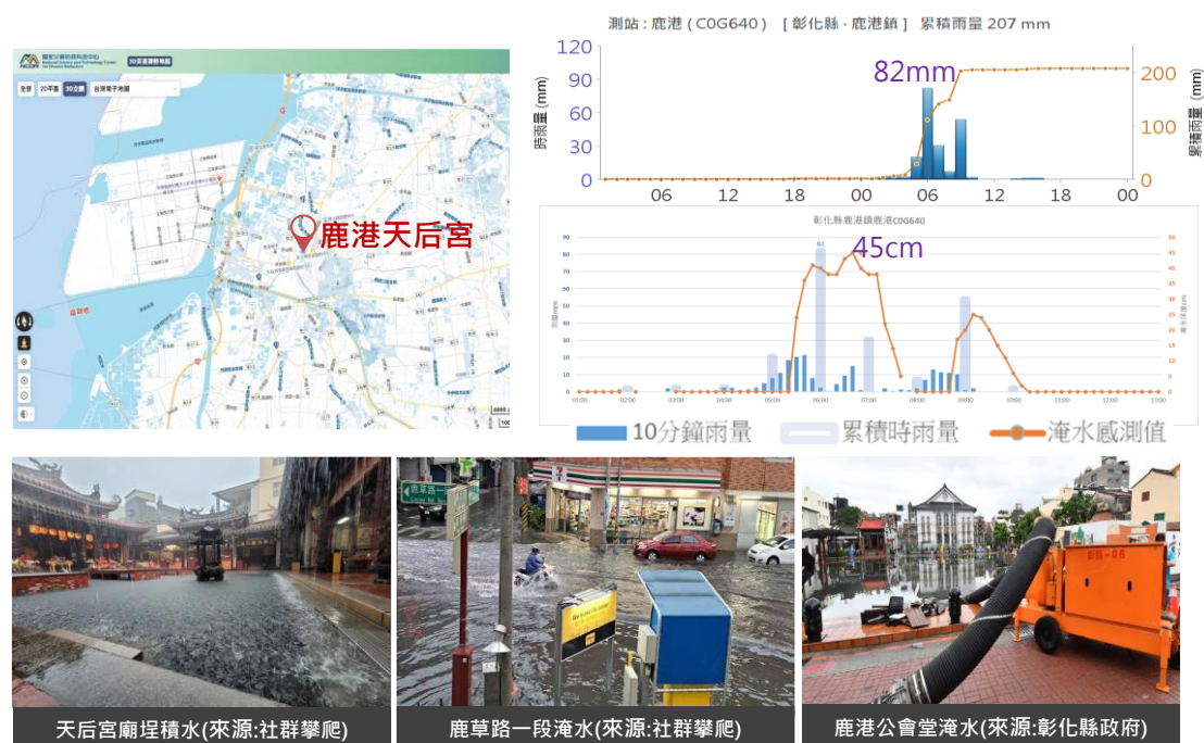
圖 1.5、彰化縣鹿港鎮淹水潛勢圖、雨量組體圖、淹水歷線圖以及災情照片(資料來源：氣象署、水利署、社群攀爬[2]、彰化縣政府；製圖：災防科技中心)
