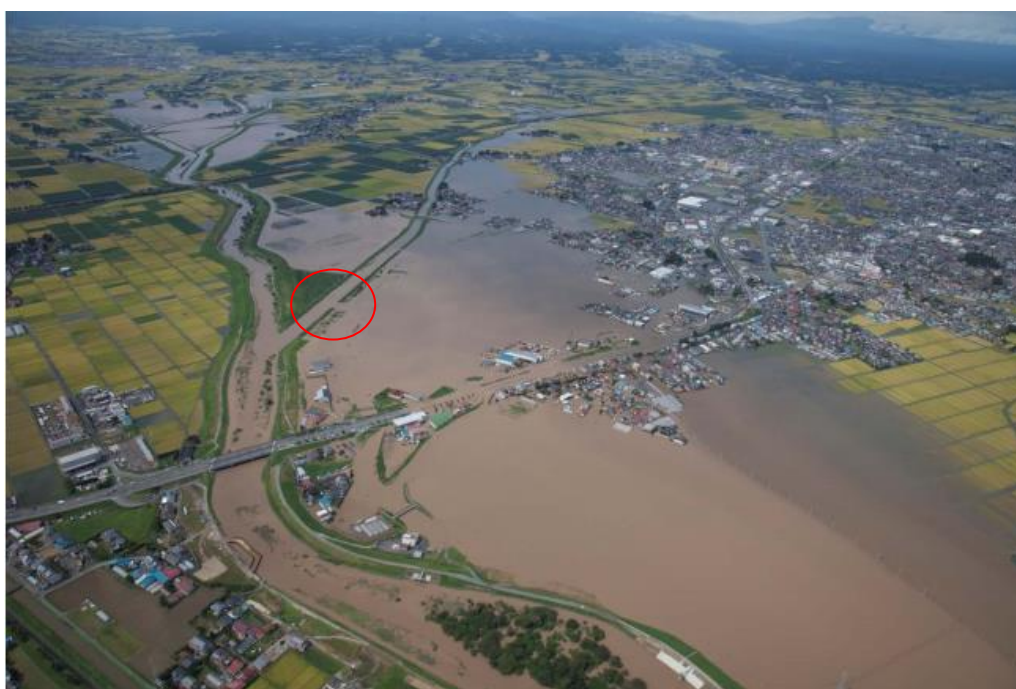
圖 5. 宮城縣涉井川潰堤航照圖(東北地方整備局)
