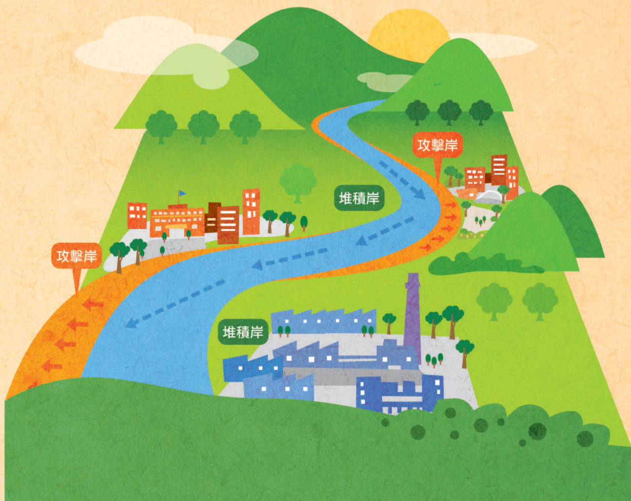
▲ 社區位於河川攻擊岸，容易因溪水淘刷邊坡而地基淘空。
